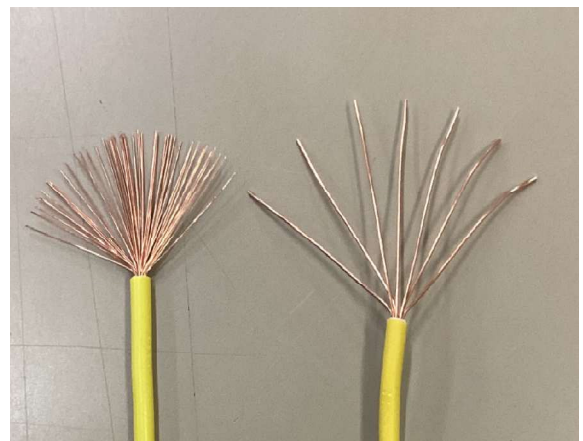
図 19 電磁リレーの信号線の違い
