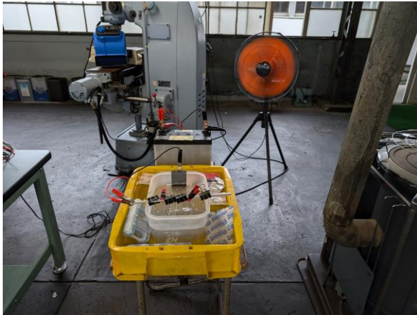
図 5 電解処理中の換気
