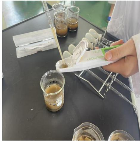
図5 硝酸イオンの測定の様子
