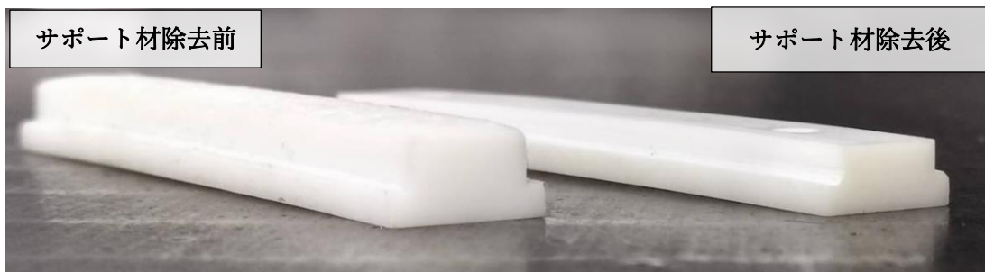
図 5 サポート材の追加工
