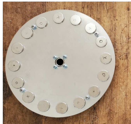
写真7 回転子 (磁極を配置したアルミ製ローター)
