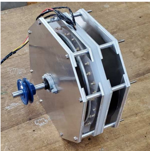
写真9 完成した発電機
