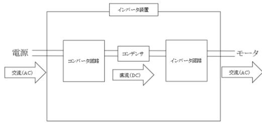
図 3-2 インバータの仕組み
