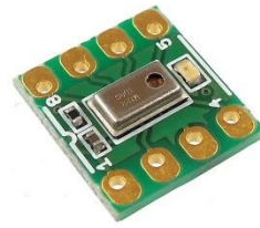
図 3 - 2 大気圧センサー-AE-MPL115A1-V2 及び出力結果
