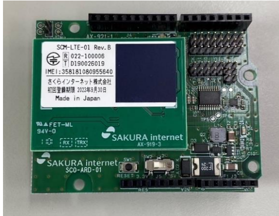
図 3 - 1 Sakura.io モジュールと Arduino シールド
