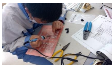
写真 7_基板製作中の様子
