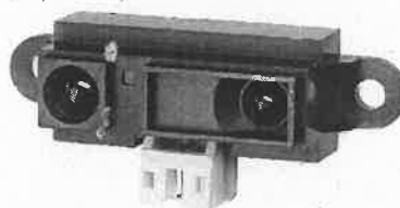
図7. シャープ測距モジュール GP2Y0A21YK
